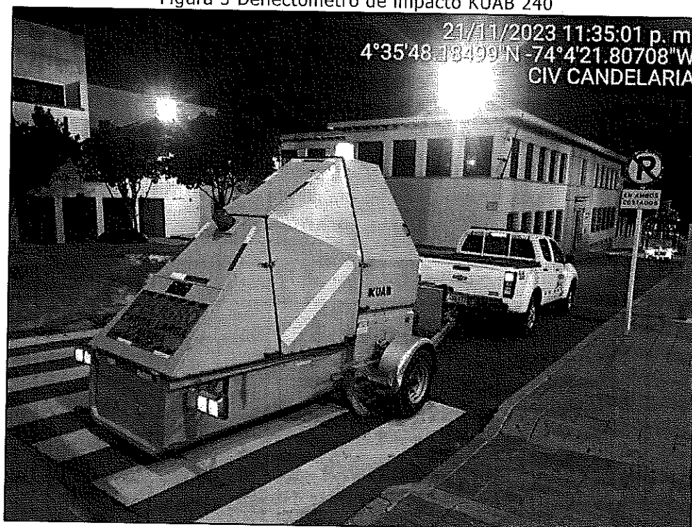
Figura 3 Deflectómetro de impacto KUAB 240
